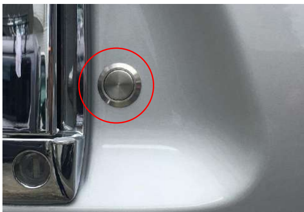
開閉スイッチ外側取付位置
