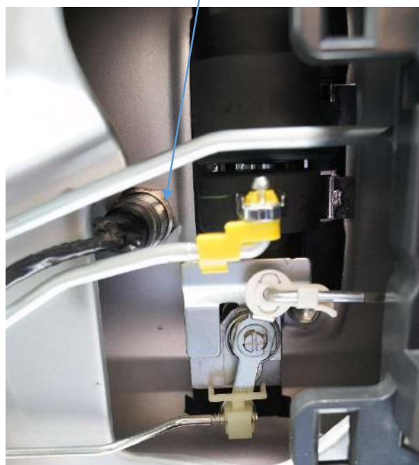
裏から付属のスパナを使いナットで固定する
