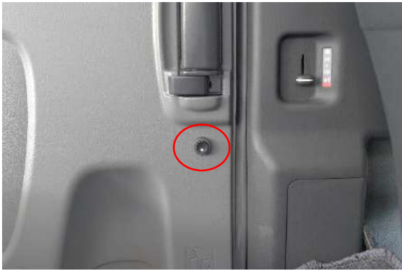
内側スイッチ取付位置
