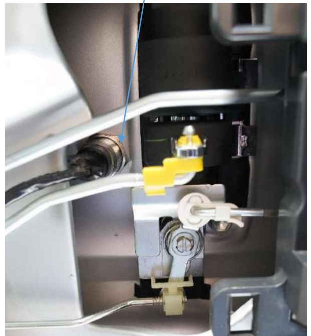
裏から付属のスパナを使いナットで固定する
